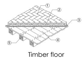
1) Terracotta tiles10) Roof tile2) Screed11) Timber I3) Waterproof breathable12) Timber Imembrane13) Wood f4) Wood decking14) Vapour5) Timber joist
